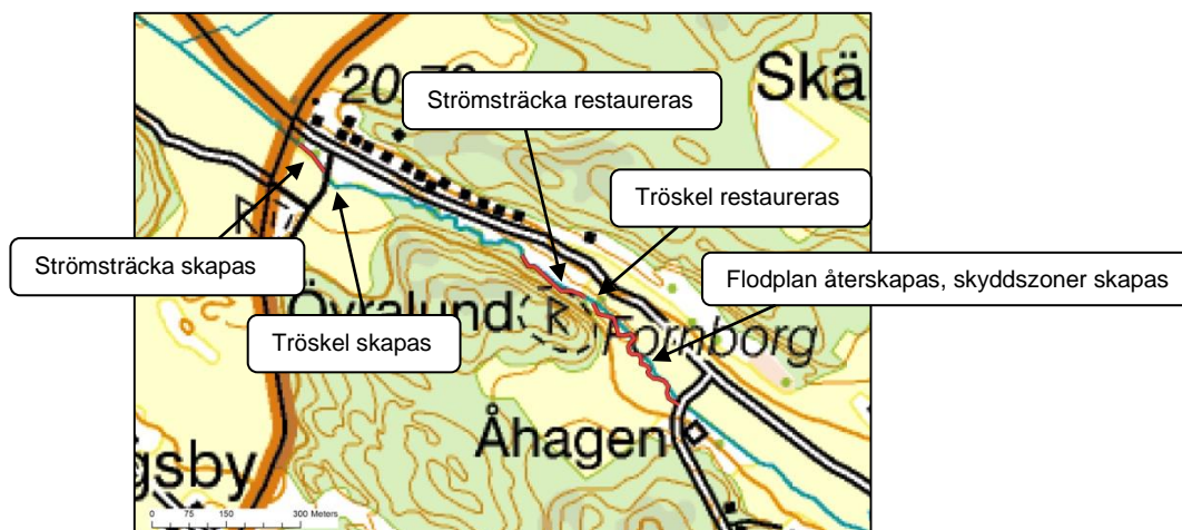
Figur 43. Översikt som visar åtgärdsförslag 16 (textrutorna på södra sidan) samt åtgärdsförslag 17 (textrutorna på norra sidan) för Lokal E i Bjärkusaån. Åtgärdsförslag 16 innebär att en strömsträcka skapas som övergår till en tröskel i övre del. Tröskeln dimensioneras så att vattennivån uppströms tröskeln når upp till flodplanet vid ett 1.5-årsflöde. Åtgärdsförslag 17 innebär att en strömsträcka återskapas och att strömsträckan i övre delen ska utgöra en tröskel som ska hålla samma vattennivå som den gjort ursprungligen. Åtgärdsförslag 17 innebär också att flodplanet uppströms strömsträckan restaureras genom att rensmassor avlägsnas varefter en skyddszon skapas kring vattendraget.
