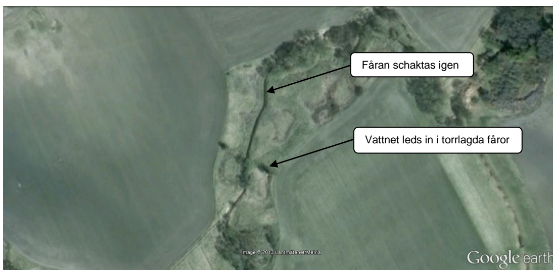
Figur 24. Principskiss över åtgärdsförslag 17 på Lokal C, Delområde 1 i Vadsbäcken. Åtgärden innebär att befintligt dike schaktas igen och att vattnet leds in i gamla fåran. För ytterligare detaljer se även Delområde 1. Observera att en förutsättning för att åtgärden ska kunna utföras är att även Delområde 2 åtgärdas, annars blir vattennivån inte rätt.
